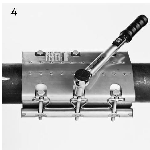
Mit Drehmomentschlüssel wechselseitig auf das vorgeschriebene Drehmoment anziehen. (siehe Typenschild) **Achtung: Verschluss schraube nie über das Drehmoment anziehen.**
