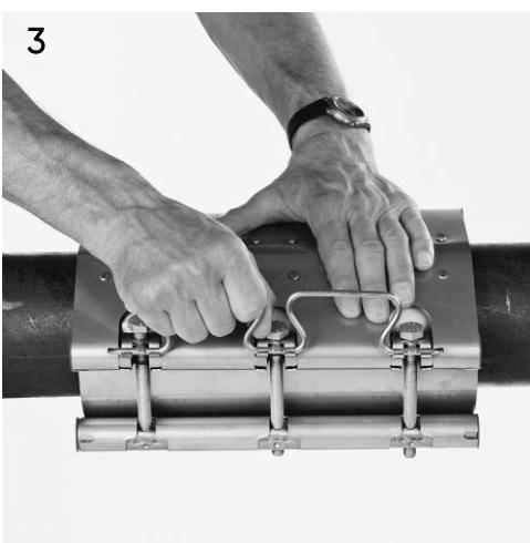
Verschluss einhaken. Schrauben abwechselnd und gleichmäßig anziehen.
