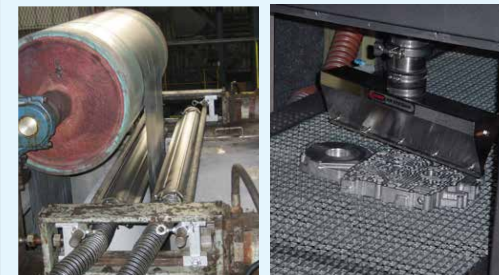
Odstranění válcovací emulze při výrobě pásu, sušení odlitků
